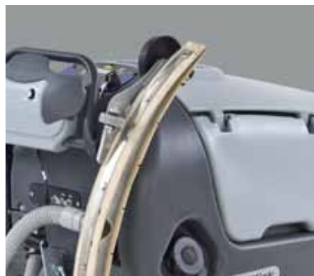
Det innebygde naloppfenget gjør det enkelt å transportere maskinen gjennom døråpninger og smale korridorer
