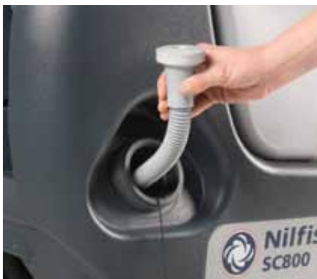
Innebygd påfyllingslange gjør det enkelt og raskt å fylle rentvannstanken
