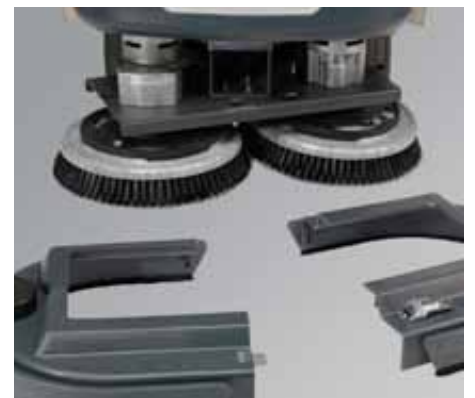
Takket være de nye avtagbare beskyttelsesplatene, er børstedekket lett tilgjengelig
